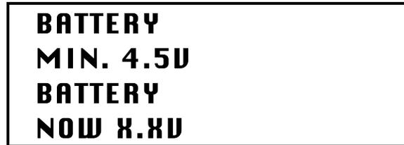
El valor X.XV tiene que ser más alto de 4.5V para que el EAGLE funcione apropiadamente (reemplazar las baterías antes de llegar al voltaje de 4.5V).
