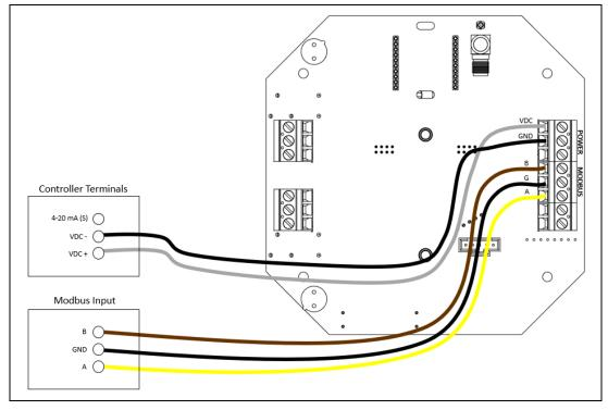
Figure 17: Modbus Wiring, Relay Version
